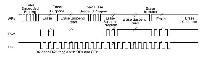
**Note:** Both DQ6 and DQ2 toggle with OE# or CE#. See the text on DQ6 and DQ2 in the section "Write Operation Status" for more information.
