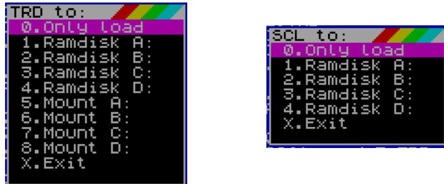
Выбранный образ можно загрузить без изменения букв реального/виртуального дисковода, загрузить в рамдиск с переключением реального и виртуального дисковода на указанную букву или смонтировать.
