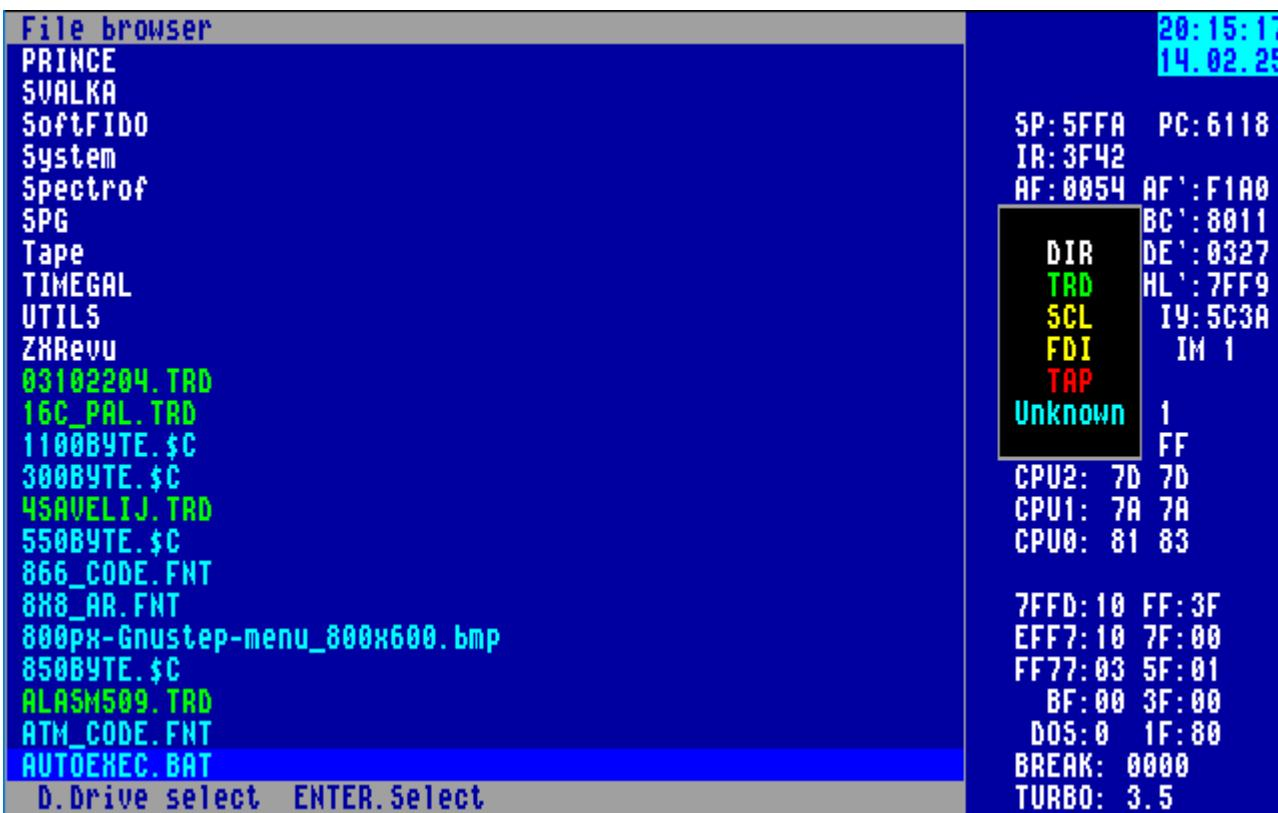
Файлы ТАР всегда загружаются в память. Для файлов SCL и FDI выводится меню выбора действий: только загрузка в рамдиск или загрузка в рамдиск и переключение реального и виртуального дисковода на указанную букву. Для файлов TRD к предыдущем возможностям добавляется возможность монтирования.
